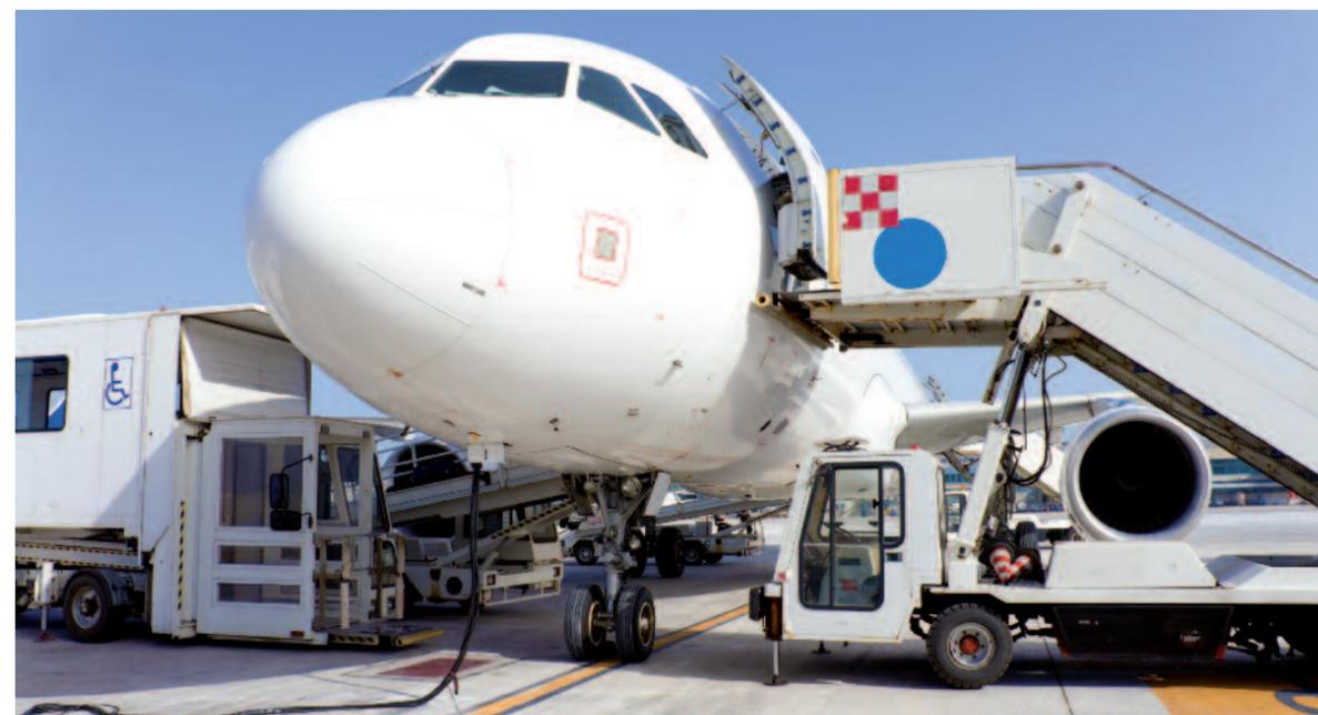
aeroplani o navi, in questi mezzi la frequenza della tensione di alimentazione è di 400Hz: pertanto, trasformatori e motori hanno dimensioni di circa la metà di quelle degli stessi apparecchi a 50 o 60Hz.
